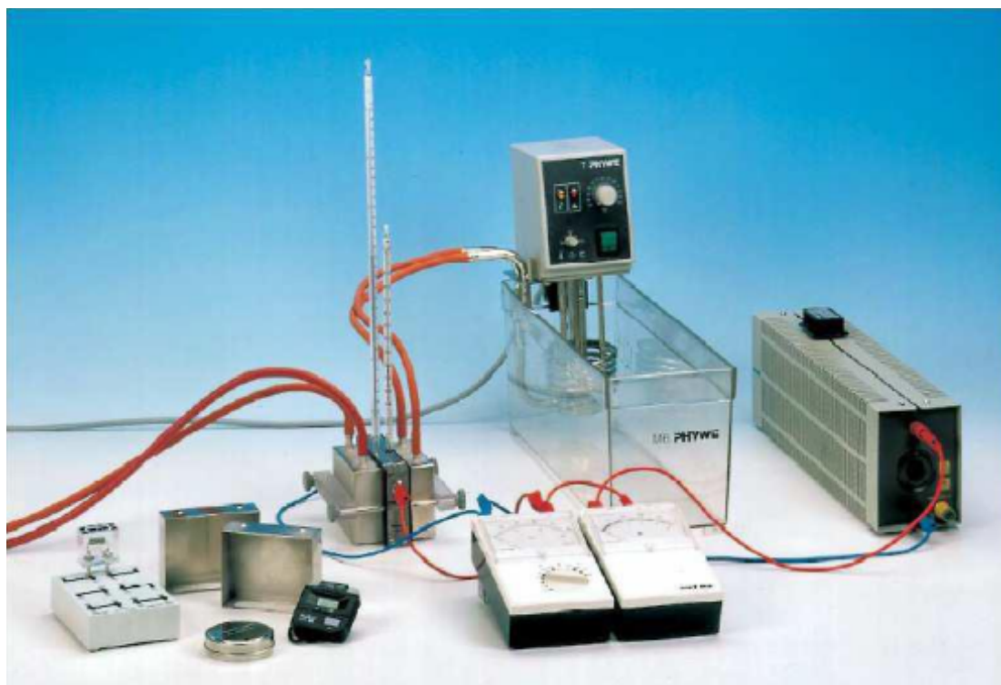
Figure 1: Montaj experimental pentru măsurarea tensiunii în gol și măsurarea intensității de scurtcircuit în funcție de diferența de temperatură
